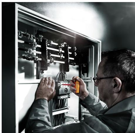
Los nuevos indicadores del par de giro con mango transversal disponen de un par de apriete fijo y no modificable de 4 o 5 Nm, y en la version VDE han sido comprobados hasta los 1.000 voltios pieza por pieza.
